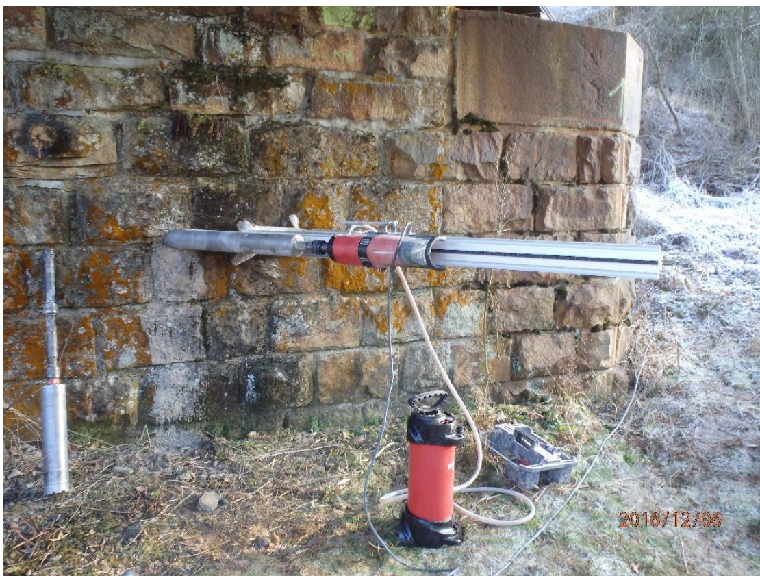
Obr. 2: Vodorovný vrt do opěry O 01 (vrt č. 1)
