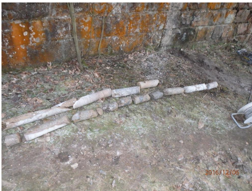
Obr. 4: Jádra vrtů do opěry O 01 (vrty č. 1,2)
